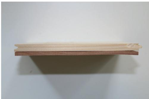
Nach Trockenlagerung delaminierter Prüfkörper
