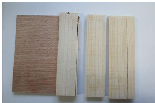
Nach Wechsellagerung detektierte Fehlverklebung
