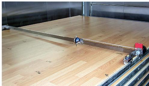
Prüfregal des IHD mit aufgesetzter Messbrücke (Prüffläche 3m x 2m)
