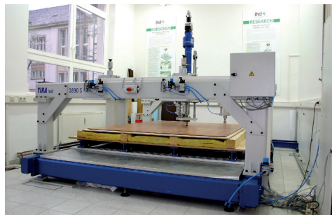
Systemprüfmaschine - Prüfung eines kompletten Deckenaufbaus
