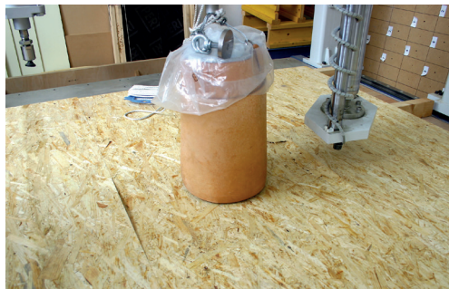
Prüfung von tragenden Bodenbelägen auf weichen Stoß
