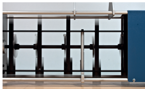
Fig. 4: Standard tapping machine to excite noise per DIN EN ISO 140-8 respectively DIN EN ISO 10140-5 (impact noise)
