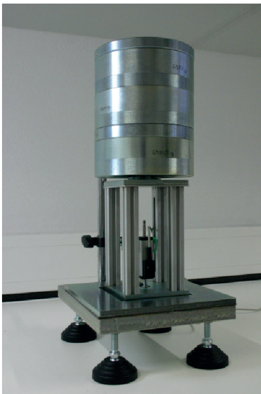
Prüfstand zur Bestimmung der Beständigkeit gegen dauerhaft einwirkende Lasten
