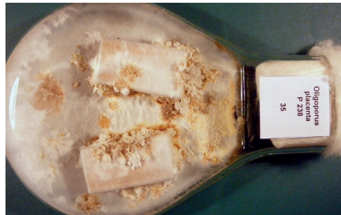
Pilzprüfung von thermisch modifiziertem Holz (TMT)
