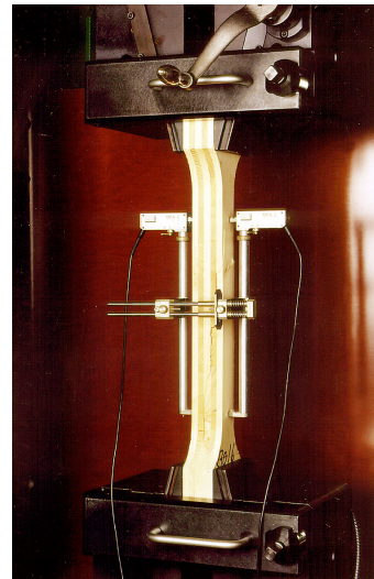
Zugprüfung an Massivholzplatten
