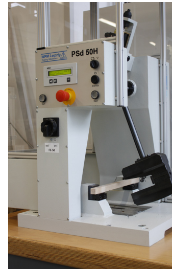
Prüfung der Bruchschlagarbeit
