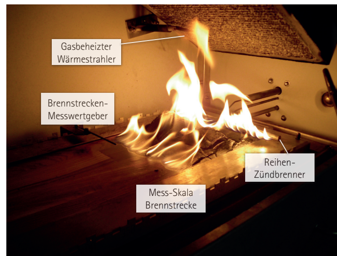
Radiant Panel Test gemäß EN ISO 9239-1
