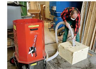
Prüfkörpervorbereitung (lose Dämmstoffe)
