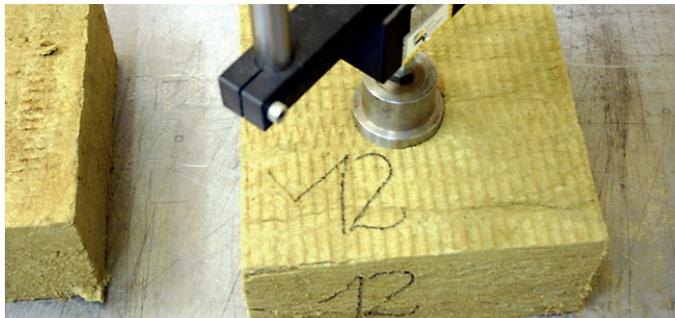
Prüfung des Verhaltens unter Punktlast
