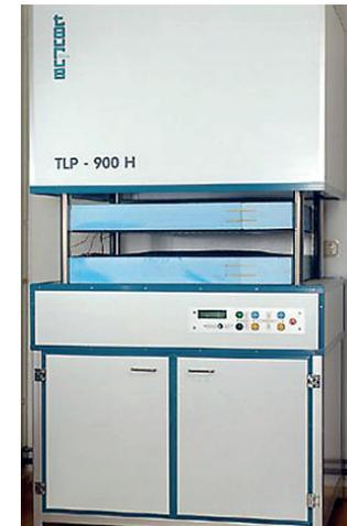
Zweiplattengerät zur Messung des Wärmedurchgangswiderstandes
