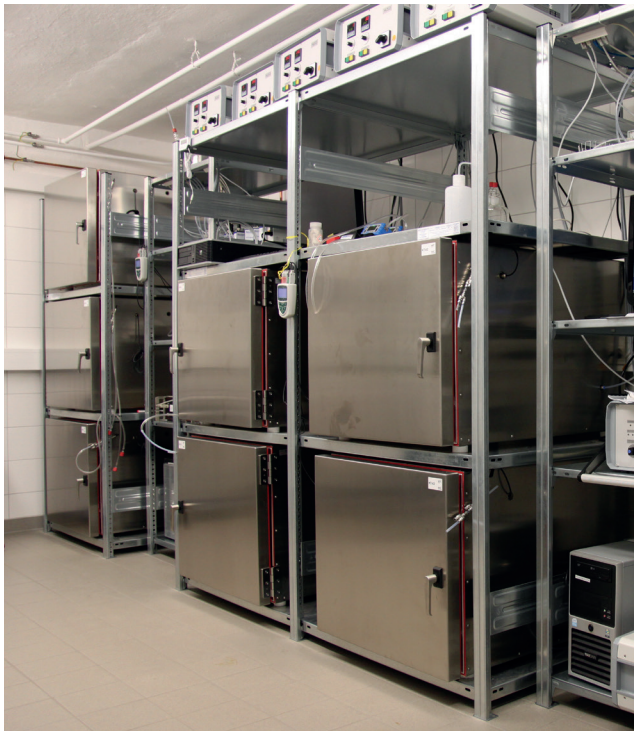
Kleine Prüfkammern zur Bestimmung der Formaldehydemissionen nach ASTM D 6007 sowie VOC-Emissionen z. B. nach DIN EN 16516
